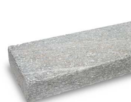
Luserna Gneis v2 > blaugrau > Ober- und Unterlager naturgespalten, Seiten gesägt, Ansicht geflammt > ø ca. 15/35 cm: 100*/150**/200** cm Herkunft: Italien
