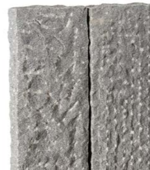
Diorit NEGRA v2 > dunkelgrau > Ansichtsseiten gesägt und sauber gespitzt, Seiten gespalten und nachgearbeitet > ø ca. 7/25 cm: 50/100/150 cm ø ca. 10/25 cm: 100/150 cm Herkunft: China oder Vietnam
