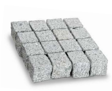
Granit VISO grau Edelpflaster v2 > grau > Ober und Unterlager gesägt, Oberfläche gestockt/geflammt, Unterseite teilweise angeraut, Seiten gespalten > ca. 5 x 5 x 5 / 9 x 9 x 5 / 9 x 9 x 8 / 10 x 10 x 8** / 16 x 16 x 16** / 22 x 15 x 15 (alle Angaben in cm) Herkunft: China oder Vietnam
