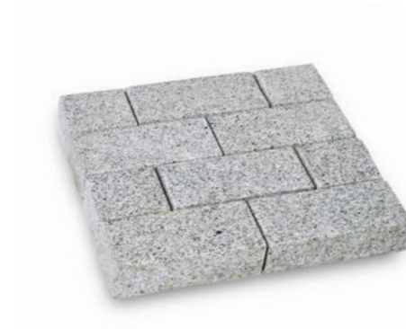
Granit GALLICIA Pflasterklinker v2 > grau > allseits gesägt, Oberfläche geflammt, Kanten leicht gefast > ca. 20 x 10 x 5 cm Herkunft: China oder Vietnam
