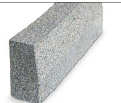
Granit - Bordstein v2 > grau > allseits gesägt oder gesägt und Ansicht gestockt Die Bordsteine A1, A4, A5 und B6/12 sind auch als Radien lieferbar. Radien: r = 0,5/1,0/2,5/5,0 und 7,5 m* Herkunft: China oder Vietnam
