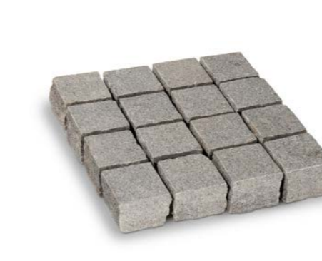
Diorit NEGRA Edelpflaster v2 > dunkelgrau > Ober und Unterlager gesägt, Oberfläche geflammt, Unterseite teilweise angeraut, Seiten gespalten > ca. 5 x 5 x 5 cm, ca. 9 x 9 x 8 cm Herkunft: China oder Vietnam
